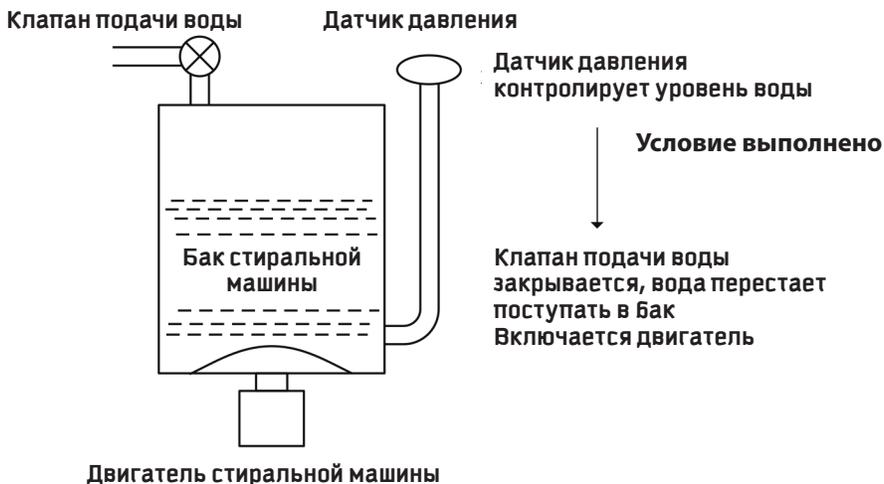
Датчик давления измеряет уровень воды и переключает машину на другой режим работы
