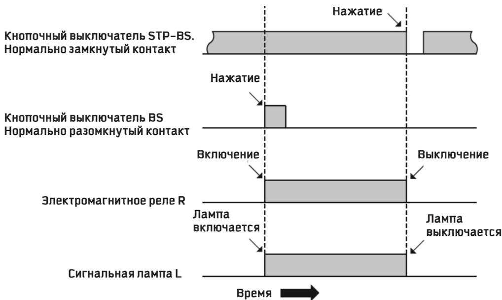
При нажатии на кнопочный выключатель BS реле R включается, и загорается сигнальная лампа L.
