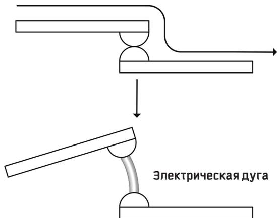
При размыкании цепи из-за разницы потенциалов между контактами возникает явление, называемое электрической дугой, в результате чего в действительности электричество продолжает течь по цепи, несмотря на разомкнутый контакт.
