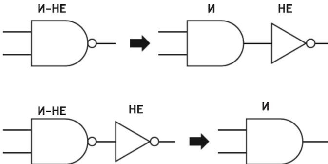
Поскольку схема И-НЕ – это результат соединения схем И и НЕ, если добавить еще одну схему НЕ, получится схема И.
