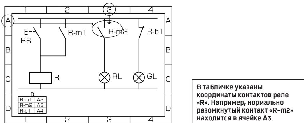
*Схема 4.6. Использование координатных блоков*
