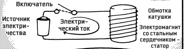
КОГДА ПО ОБМОТКЕ КАТУШКИ РЕЛЕ НАЧИНАЕТ ТЕЧЬ ТОК, В НЕЙ ВОЗНИКАЕТ МАГНИТНОЕ ПОЛЕ, ДЕЙСТВУЮЩЕЕ НА СТАЛЬНУЮ ПОДВИЖНУЮ ПЛАСТИНКУ, НАЗЫВАЕМУЮ ЯКОРЕМ. В РЕЗУЛЬТАТЕ ДЕЙСТВИЯ МАГНИТНОГО ПОЛЯ НА ПЛАСТИНКУ ВОЗНИКАЕТ СИЛА, ПЕРЕМЕЩАЮЩАЯ ПОДВИЖНЫЕ КОНТАКТЫ, ПРИКРЕПЛЕННЫЕ К НЕЙ. ЕСЛИ ОТКЛЮЧИТЬ ТОК, МАГНИТНОЕ ПОЛЕ ИСЧЕЗНЕТ, И ПРУЖИНА ВЕРНЕТ КОНТАКТЫ В ИСХОДНОЕ ПОЛОЖЕНИЕ.
