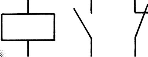
КРОМЕ ТОГО, СУЩЕСТВУЮТ ЭЛЕКТРОМАГНИТНЫЕ РЕЛЕ С КОНТАКТАМИ, ВЫДЕРЖИВАЮЩИМИ ОЧЕНЬ БОЛЬШИЕ ТОКИ, КОТОРЫЕ ИСПОЛЬЗУЮТСЯ, КОГДА НЕОБХОДИМО УПРАВЛЯТЬ ТОКАМИ ПРИ ВКЛЮЧЕНИИ, НАПРИМЕР, МОЩНОГО ЭЛЕКТРОДВИГАТЕЛЯ. ТАКИЕ РЕЛЕ НАЗЫВАЮТСЯ "МАГНИТНЫМИ ПУСКАТЕЛЯМИ".
