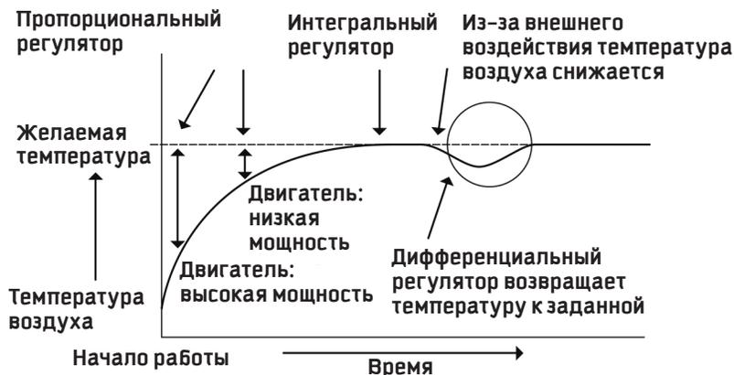
Схема 2.14. Изменение температуры при использовании дифференциального регулятора
