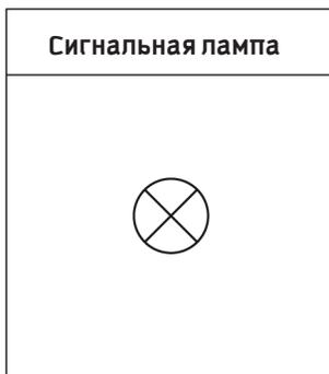
Схема 3.27. Условное обозначение сигнальной лампы
