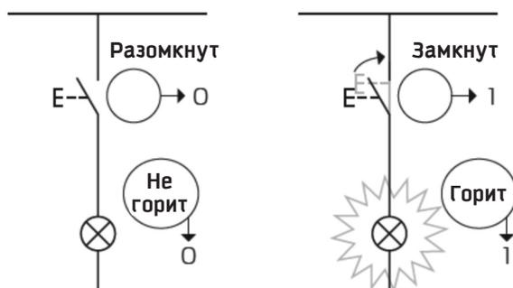
Схема 5.1. Принципиальные схемы, соответствующие двум состояниям сигнальной лампы
