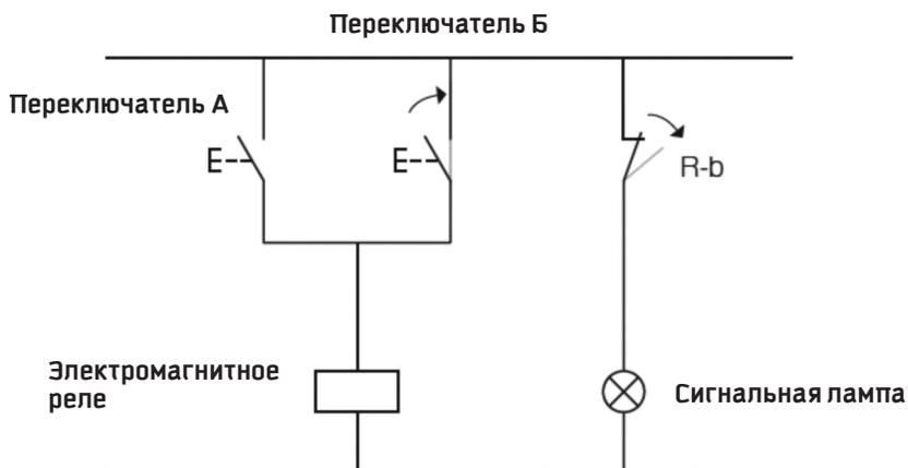
Схема 5.6. Модель схемы ИЛИ-НЕ на механических переключателях
