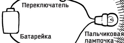
ТАКАЯ ЭЛЕКТРИЧЕСКАЯ СХЕМА ЯВЛЯЕТСЯ ПРОСТЕЙШЕЙ СИСТЕМОЙ УПРАВЛЕНИЯ, ПОСКОЛЬКУ, МАНИПУЛИРУЯ ПЕРЕКЛЮЧАТЕЛЕМ, МЫ МОЖЕМ ЗАЖИГАТЬ И ГАСИТЬ СВЕТ В ЛАМПОЧКЕ.
