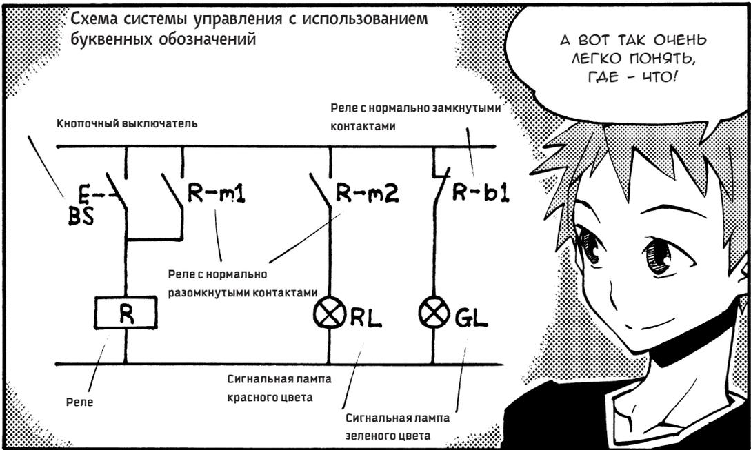
Схема системы управления с использованием буквенных обозначений
