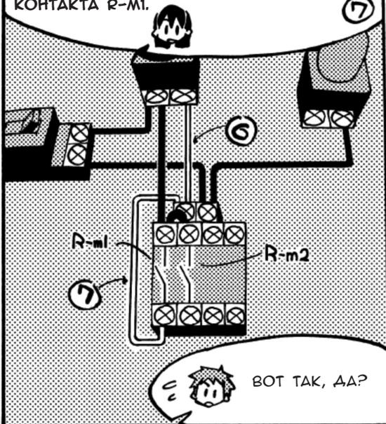
НУ И НАКОНЕЦ, ЕСЛИ ПОДКЛЮЧИТЬ НИЖНЮЮ КЛЕММУ НОРМАЛЬНО РАЗОМКНУТОГО КОНТАКТА ЭЛЕКТРОМАГНИТНОГО РЕЛЕ R-m2 К ЛЕВОЙ КЛЕММЕ СИГНАЛЬНОЙ ЛАМПЫ, ЭЛЕКТРИЧЕСКАЯ СХЕМА БУДЕТ ЗАВЕРШЕНА.
