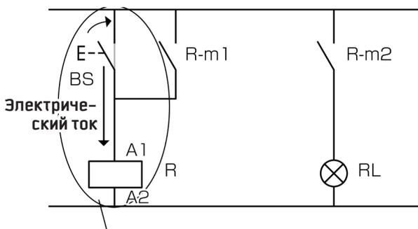
Если нажать на кнопочный выключатель «BS», по катушке электромагнитного реле потечет ток, и реле переключится
