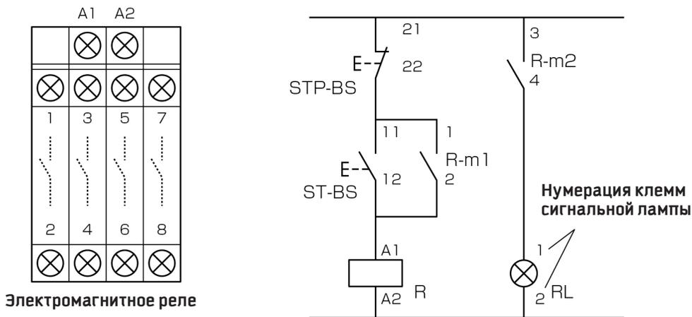
Схема 4.4. Схема системы управления с пронумерованными клеммами
