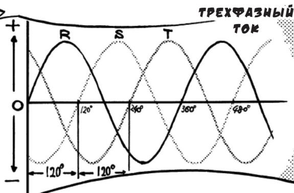
ФАЗНЫЕ НАПРЯЖЕНИЯ И СООТВЕТСТВУЮЩИЕ ПРОВОДА ОБОЗНАЧАЮТ БУКВАМИ R, S, T ИЛИ L<sub>1</sub>, L<sub>2</sub>, L<sub>3</sub>.
