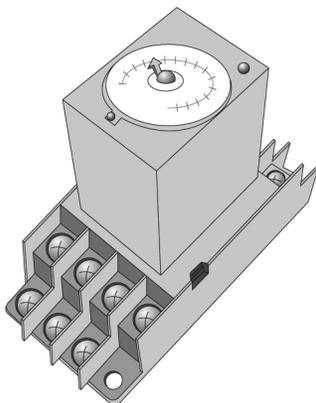
Схема 3.19. Таймер
