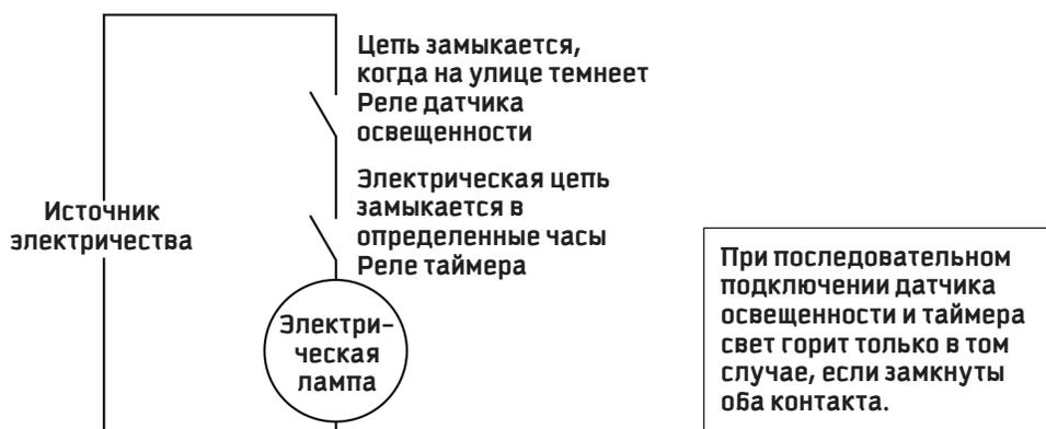
Схема 1.6. Совместное подключение датчика освещенности и таймера
