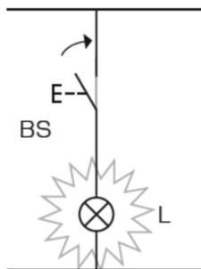
Схема 6.1. Кнопочный выключатель и сигнальная лампа
