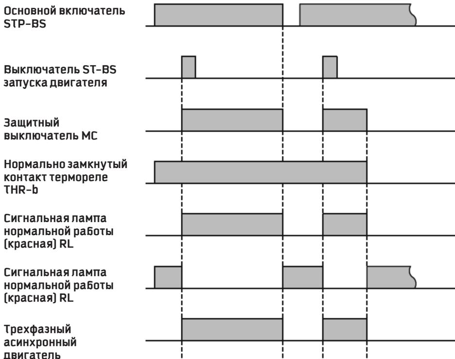
Схема 6.15. Временная диаграмма работы схемы защитного отключения двигателя
