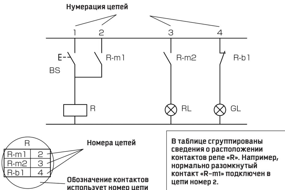
*Схема 4.5. Использование в схеме нумерации цепей*
