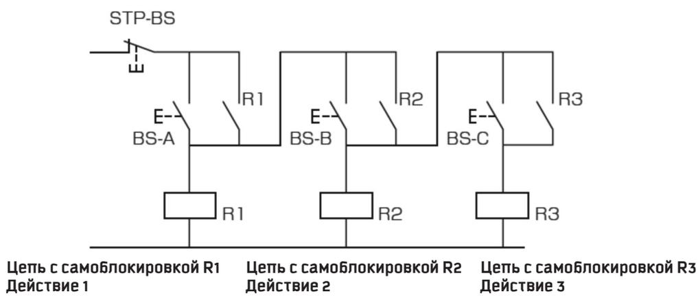
Схема 6.10. Схема с последовательным включением
