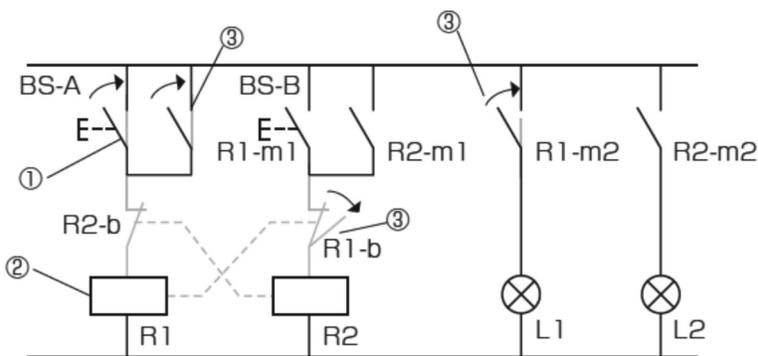
Цепь блокировки, которая не позволяет включиться одновременно реле R1 и R2
