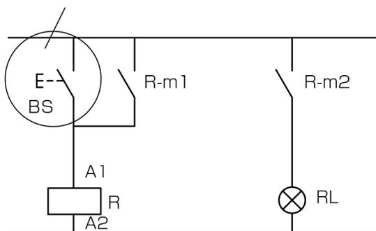
Согласно основным правилам, устройства, которые первые начинают работу, расположены на схеме системы последовательно управления в левом верхнем углу.
