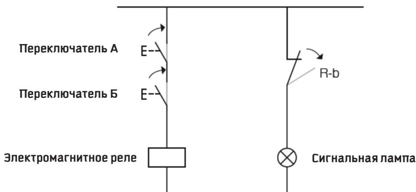
*Схема 5.5. Модель схемы И-НЕ на механических переключателях*
