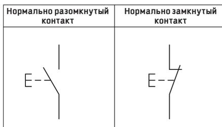
Схема 3.2. Обозначения контактов кнопочного выключателя
