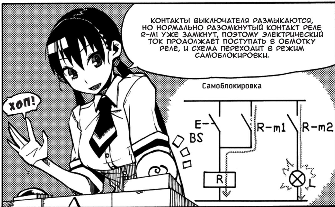
КОНТАКТЫ ВЫКЛЮЧАТЕЛЯ РАЗМЫКАЮТСЯ, НО НОРМАЛЬНО РАЗОМКНУТЫЙ КОНТАКТ РЕЛЕ R-M1 УЖЕ ЗАМКНУТ, ПОЭТОМУ ЭЛЕКТРИЧЕСКИЙ ТОК ПРОДОЛЖАЕТ ПОСТУПАТЬ В ОБМОТКУ РЕЛЕ, И СХЕМА ПЕРЕХОДИТ В РЕЖИМ САМОБЛОКИРОВКИ.
