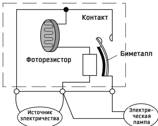
Схема 1.4. Работа биметаллического выключателя в датчике освещенности
