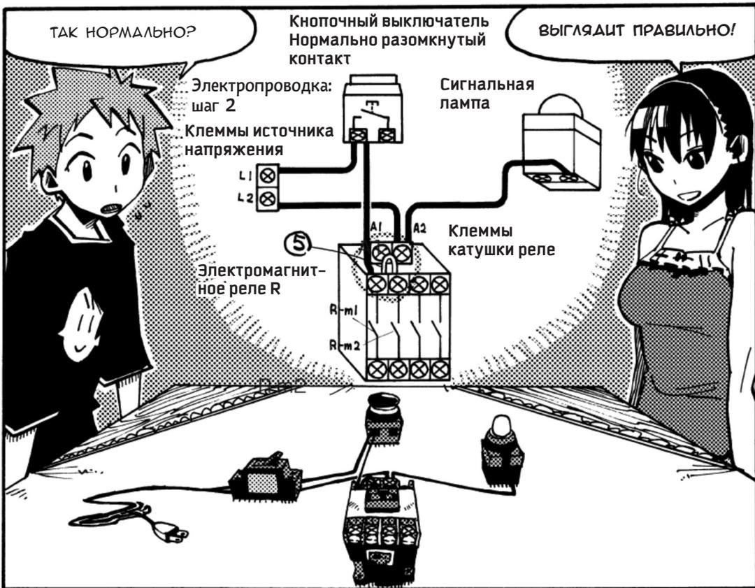
ЗАТЕМ ПОДКЛЮЧАЕМ ПРАВУЮ КЛЕММУ КНОПОЧНОГО ВЫКЛЮЧАТЕЛЯ К КЛЕММЕ A1 ЭЛЕКТРОМАГНИТНОГО РЕЛЕ.
