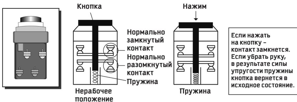
Схема 3.1. Устройства кнопочного выключателя
