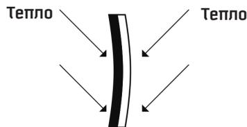
При повышении температуры пластинка изгибается
