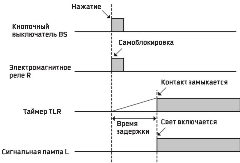
Рис. 6.9. Временная диаграмма работы схемы с задержкой включения
