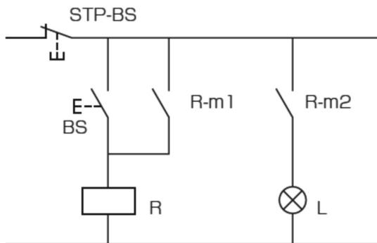
Схема 6.5. Схема с самоблокировкой, включающая сигнальную лампу
