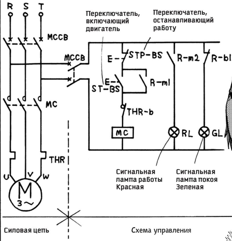
В ТАКИХ СХЕМАХ ПРОВОДКА, КОТОРАЯ ИДЁТ ОТ ИСТОЧНИКА ТРЕХФАЗНОГО ТОКА К ДВИГАТЕЛЮ, НАЗЫВАЕТСЯ СИЛОВОЙ ЦЕПЬЮ.
